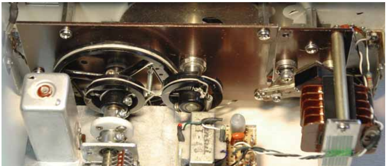
2 重系掛け式ダイヤル機構と AF-Q マルチプライヤー用可変インダクター
