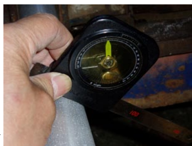
万力の水平を確認パイプをはさみ固定する。
