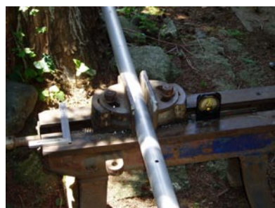
万力の水平を確認パイプをはさみ固定する。
