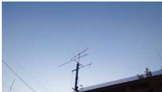
ポールのとっぺんのデルタループ
