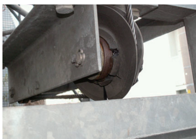
樹脂部分が完全に脱落したプーリー
