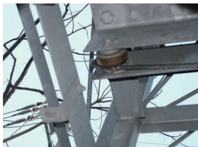
樹脂部分が完全に脱落したプーリー
