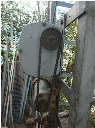
巻き上げ機のケースを外しモーターの取り付けねじを緩めてチェーンをはずします。
