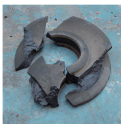
樹脂部分が完全に脱落したプーリー
