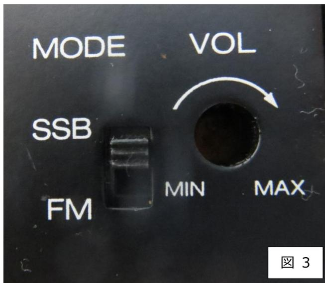
図 3 スタンドマイク AM0308（アドニス）の底面にある、モード切替スイッチとマイクゲイン調整半固定 VR。私は AM では SSB モードに、半固定 VR は中央からやや MAX 寄りにしました。
