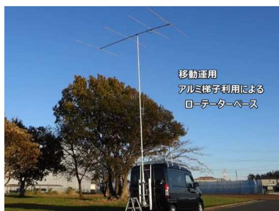
基本的に引っかけるだけでも無風ならいいのですが、風が吹くとアウトなので、ベルトなどで下部を縛るようにしています。風があれば、もちろんアンテナのステーも必要です。
