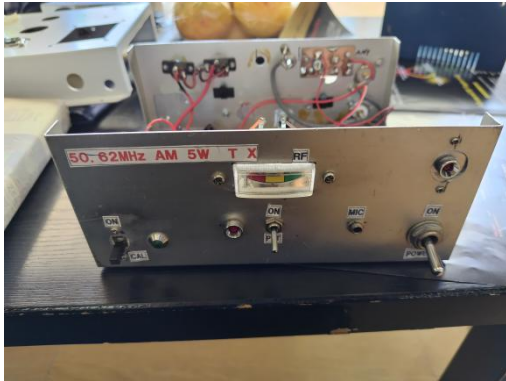
JR0PHS 堀内 OM 自作の 50MHz AM 5W 送信機 各誌の製作記事を元に組合せて、送信機にしました
