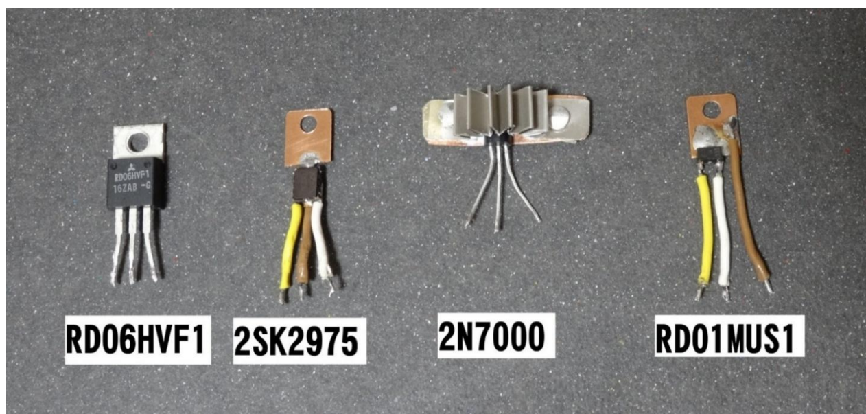
写真1 測定した4種類のMOSFET (リード線や放熱フィンを取り付けた状態)
