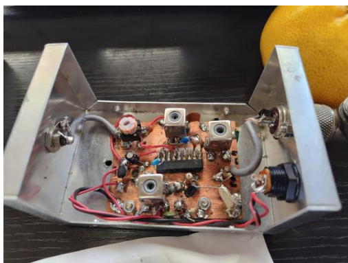
JR0PHS 堀内 OM 自作の 50MHz クリスタルコンバータ CQ 誌 2021 年 8 月号 JA1UDY/2 三浦 OM の製作記事より
